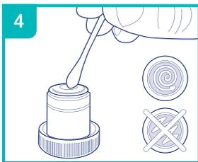
Reinigen Sie das Objektiv mit der Spitze des Wattebauschs oder dem Linsenpapier\*. Wenn Sie eine große Linsenfläche reinigen, wischen Sie kreisförmig mit leichtem Druck von der Mitte zur Peripherie. Zick-Zack-Bewegungen sollten vermieden werden. Entsorgen Sie jedes Linsenpapier bzw. jeden Wattebausch nach einmaligem Gebrauch.
